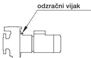
Zaporni ventil u usisnom vodu polagano otvarati, sve dok medij ne počne izlaziti na odzračnom otvoru.
