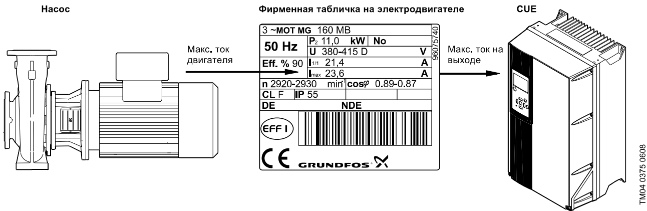
Рис. 95 Подбор CUE на основании максимального тока двигателя
